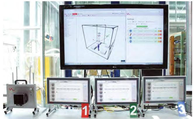
**Bild 1.** Hardware-in-the-Loop-Simulationsaufbau mit drei Flugsteuerungen (1–3), VAL-Edge-Cloud-Server (links) und VAL-3D-WebStudio (oben).
